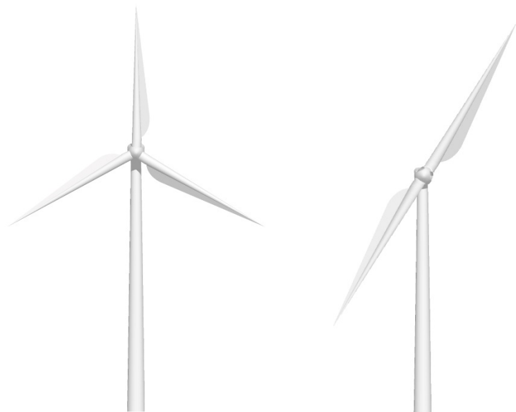
Figur 6-5. Eksempel på to- og trevingede vindmøller.
